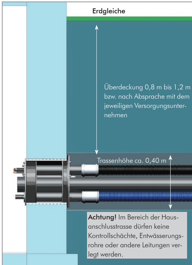
Abb. 4: Einbau Quadro-Secura® K-FW
