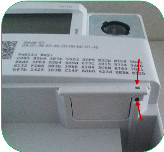
Bild 15: Plombierungsstelle von LMN Kommunikation
