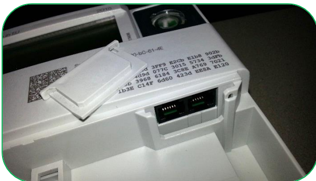
Bild 46: LMN Schnittstelle – Zugang zu RJ-12 Buchsen
