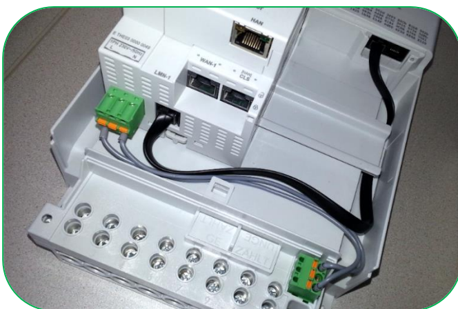
Bild 47: Verbindung SMGw an LMN-1 Stecker
