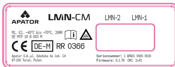
Der Adapter bildet eine Erweiterung der Zähler-Schnittstelle und ermöglicht die Kommunikation mit SMGW. Am Adapter gibt es zwei LMN-Ports (1 und 2). Beschreibung vom Anschluss des LMN-Portes,
